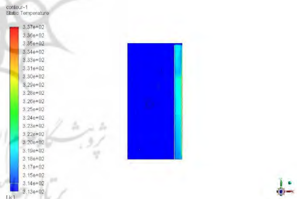
شکل ۱۵) کانتور دما در مقطع عرضی حالت A3 همراه با ابزار سایه‌انداز
