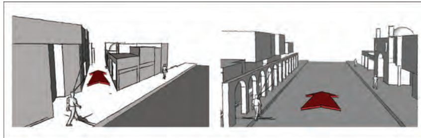
شکل ۱۲. تأثیر وسعت میدان دید بر ادراک عمق و فاصله؛ در شکل راست با وسعت دید بیشتر، فاصله و عمق کمتر از شکل چپ با میدان دید باریک به نظر می‌آید (مأخذ: Shakibamanesh, 2013)
