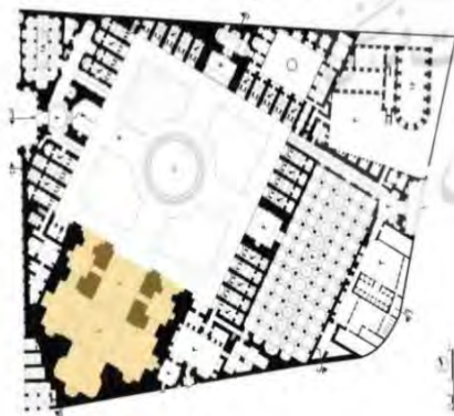
شکل ۳ (الف) فضای گنبدخانه [25] ؛ (ب) ترکیب چهار نیم‌گنبد با گنبد اصلی [25]
