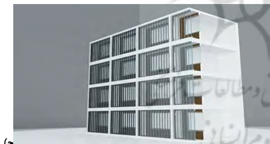
شکل ۶ مدل اتاق اداری با نمای دوپوسته: (الف) بدون سایه‌انداز، (ب) سایه‌اندازهای کرکره‌ای افقی، (ج) سایه‌اندازهای کرکره‌ای قائم
