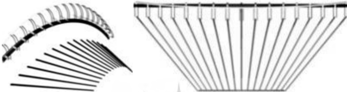
شکل ۷: راست: پلان سقف و میله های متحرک آن، چپ: نمای ۳ بعدی از استخوان بندی سازه ای و میله های طره ای متناظر آن (ترسیم: نگارندگان)
