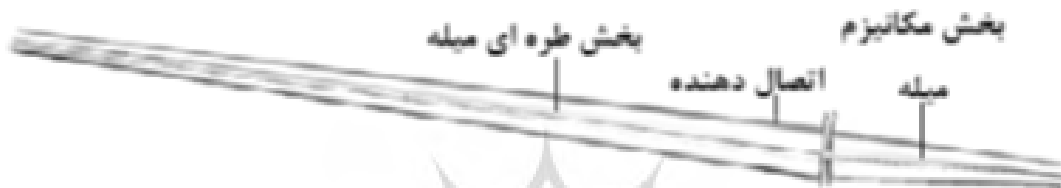
شکل ۱۲: میله متحرک با مقطع باریک شونده (ترسیم: نگارندگان)
