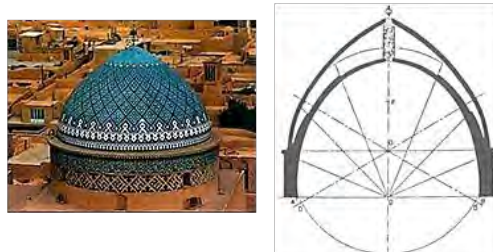
تصویر ۱۱: گنبد دو پوسته پیوسته بقعه سید رکن الدین یزد مقطع گنبد (پیرنیا، ۲۳۸، ۱۳۸۶). و نمای خارجی گنبد (www.mahoor.org)
