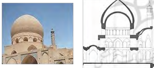
تصویر ۱۴: گنبد دو پوسته گسسته مسجد آقابزرگ کاشان. مقطع گنبد (حاجی قاسمی، ۱۳۷۵، ۱۵۷). و نمای خارجی گنبد آقابزرگ کاشان (حاجی قاسمی، ۱۳۷۵، ۱۵۳).
