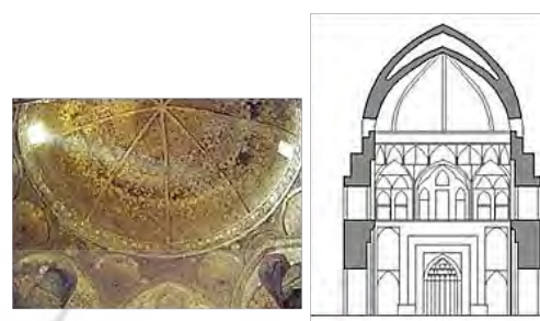
تصویر ۱۲: گنبد دو پوسته پیوسته مسجد برسیان اصفهان. مقطع گنبد (Ashkan, 2009, 105). و نمای زیر گنبد مسجد برسیان (www.shw.kousha.fotopages.com)
