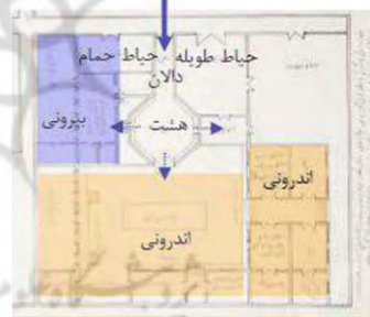
شکل ۱: رسم الگویی از خانه حاج محمد حسن امین الضرب پس از سال ۱۲۴۴ ه. ق: ۱: اندرونی ۲: بیرونی ۳: حسینیه. م. اخذ: مهدوی، ۱۹۹۹
