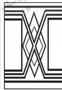
شکل ۱۴- گل میخ های میان آجری با گچ (مأخذ: نگارنده، ۱۳۹۶)
