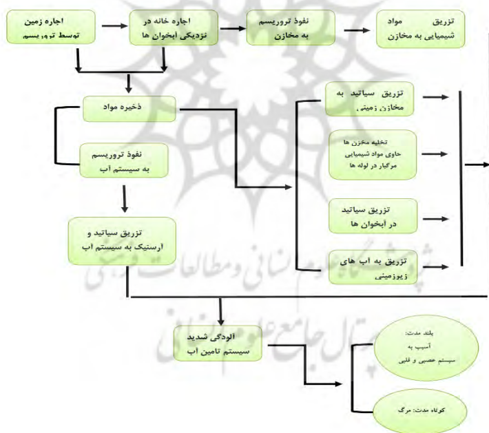
شکل (۷): آنالیز درخت رویداد حمله بیوتورویسم به زیرساخت آب با استفاده از آرسنیک و سیانید
