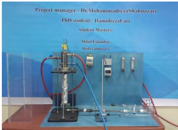
شکل ۵. سیستم آزمایشگاهی تست احتراق ناقص در محیط متخلخل
