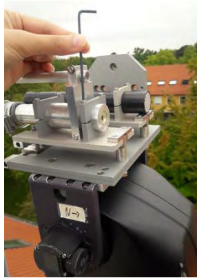
شکل ۵. واحد نگه دارنده، دهانه اپتیکی و ابزار قراولروی
