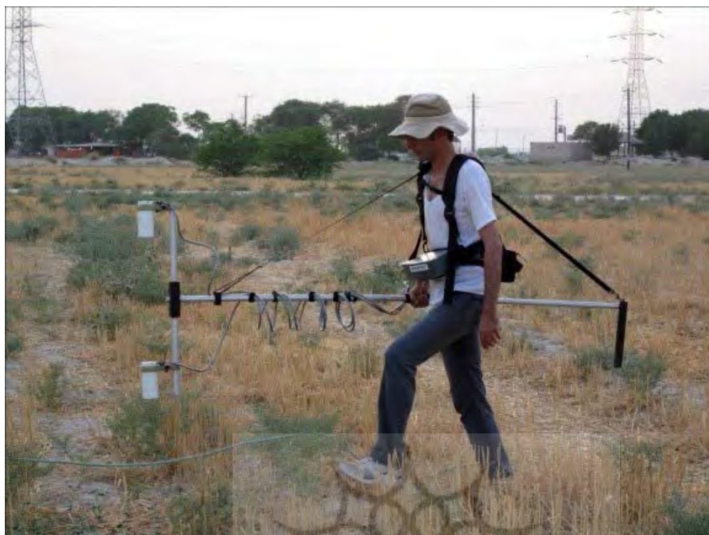
تصویر ۶. نحوه انجام بررسی آرکتئوفیزیک با استفاده از دستگاه مغناطیس‌سنجی بخار سزیم-ریدیدیم (محمدخانی، ۱۳۹۶).
