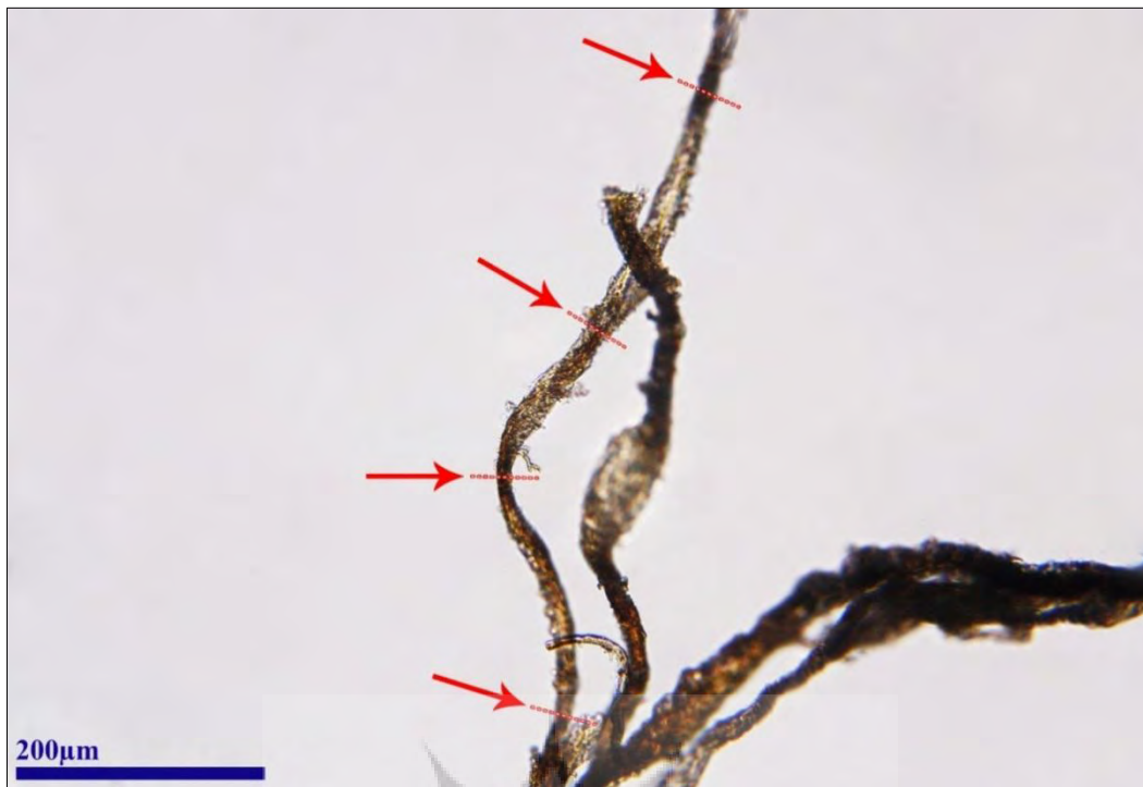
شکل ۴: بررسی میکروسکوپی ساختار زنجیره مرواریدی در الیاف کلاژن نمونه S3 Fig. 4: leather fiber of S3 sample forming the pearls on a string structure
