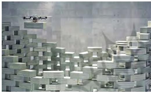
شکل ۲- استفاده از ربات‌های پرنده برای ساخت ماکت یک پروژه (ماخذ: آتیه رباتیک دانشگاه ETH Zurich)
