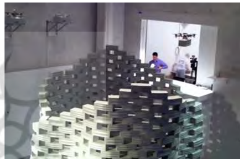
شکل ۲- استفاده از ربات‌های پرنده برای ساخت ماکت یک پروژه (ماخذ: آتیه رباتیک دانشگاه ETH Zurich)
