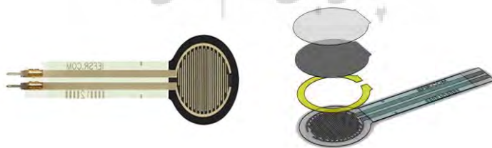
شکل ۱- نمای بالا و انفجاری سنسور FSR (۹)
