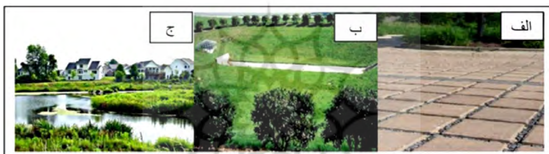
شکل (۶): الف) پیاده رو متخلخل ب) حوضچه نگهداشت خشک ج) حوضچه نگهداشت مرطوب
