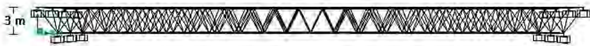
شکل ۲- نمای عرشه پل به صورت سازه فضاکار دو لایه با آرایش مربع روی مربع جابه‌جا شده (ماخذ: نگارندگان، ۱۳۹۸)
