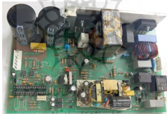
ب) برد تصحیح ضریب توان و فیلتر ورودی
