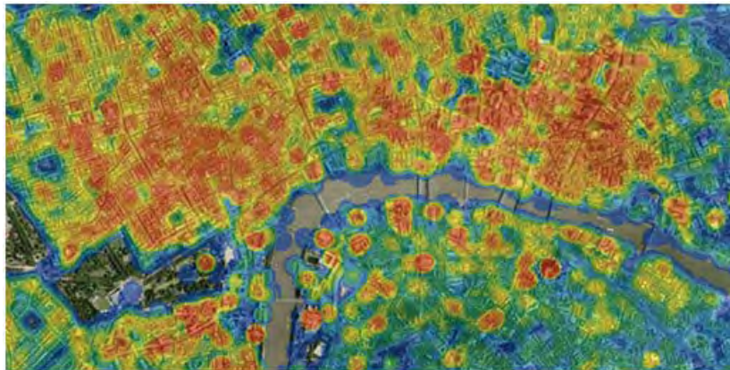
شکل: دیاگرام نمایش میزان مصرف انرژی صرف گرمایش در هر ساختمان ۹۷ ، ۲۰۱۲، انگلستان (URL-1)
