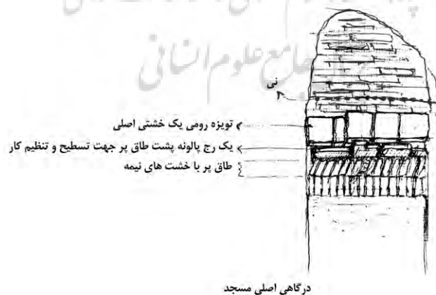
تصویر ۶: الف. رج های باقی مانده از خشت های طاق سردر کهن مسجد که داخل دیوار تراشیده شده شکل گرفته اند. ب. درگاه اصلی مسجد
