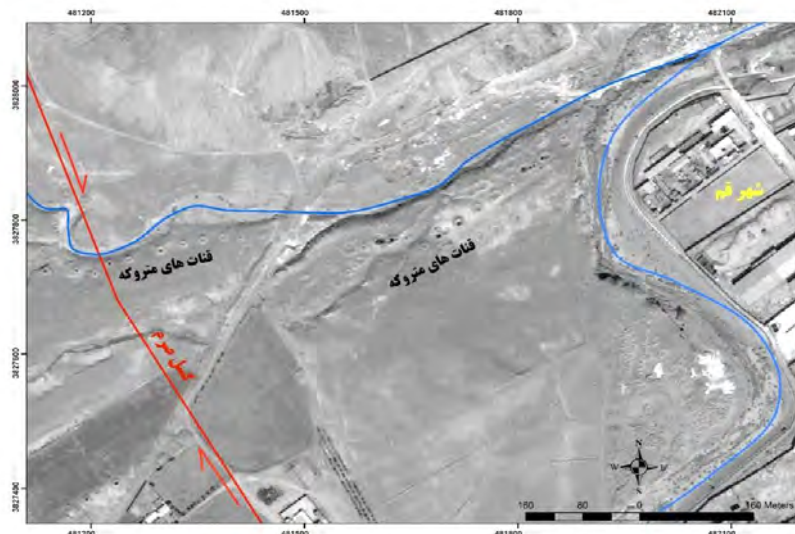
شکل ۱۳. تخریب و جابه‌جایی رشته قنات‌ها در شمال پردیسان قم بر اثر حرکات تکتونیکی (تصویر ماهواره‌ای Orb-View3 با قدرت تفکیک ۴ متر)
