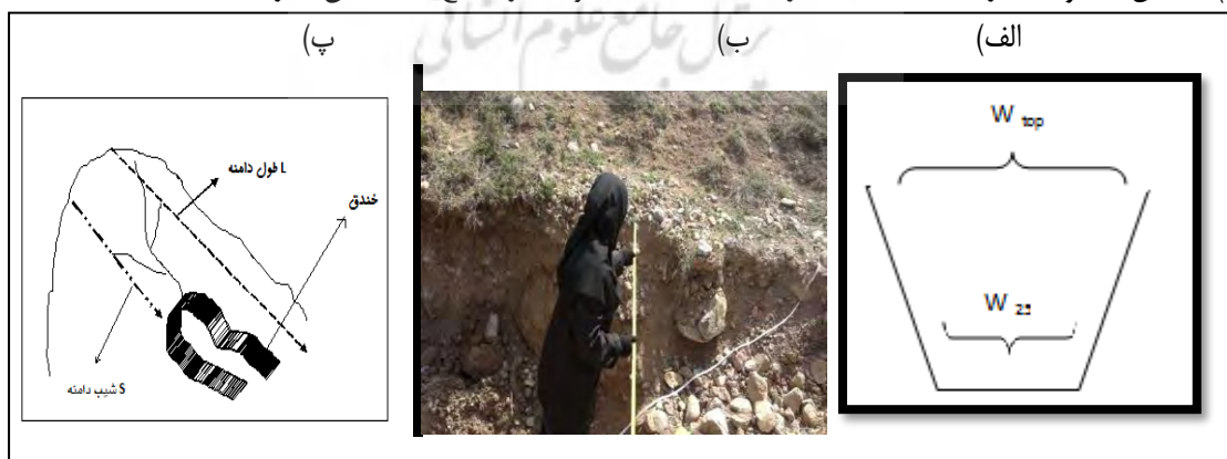
شکل (۳): الف) سنجش‌های میدانی در خندق‌های تشکیل شده در شیب‌های حوضه اوجان چای، ب) پارامترهای مورد سنجش در یک خندق بزرگ برای تعیین شکل خندق و پ) پارامترهای مربوط به برآورد میزان فرسایش در معادله فرسایش
