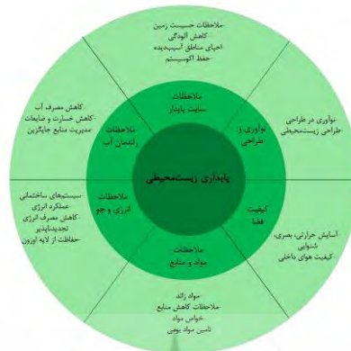
شکل شماره ۱: معیارها و زیرمعیارهای مولفه پایداری زیست‌محیطی برای مجتمع‌های مسکونی (نگارندگان)
