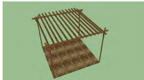
شکل ۵- قرار گرفتن تیرهای چوبی برای پوشش سقف
