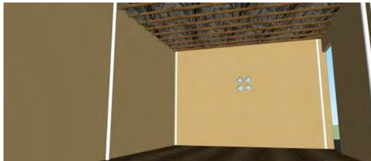
شکل ۱۲- نمای درونی یخ‌تکن با پنجره جهت جریان هوا
