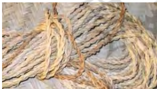
شکل ۷- چیلک، تهیه شده از برگ نخل یا داز (نخل ایرانی) برای بستن نقاط اتصال تیرهای کاوار یا بنش‌بندی
