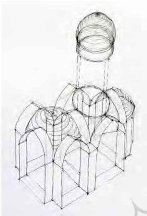
تصویر ۹. نظام سازه‌ای و شکل گنبد کلیسای هوانس مقدس. مأخذ: نگارندگان. تصویر ۱۰. گنبد و نظام سازه در کلیسای مریم مقدس. مأخذ: نگارندگان.
