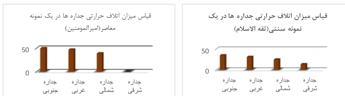
تصویرهای ۴ و ۵: اتلاف حرارتی جداره‌ها در یک نمونه سنتی و یک نمونه معاصر Fig. 4-5: Thermal loss of the walls in a traditional and a contemporary case
