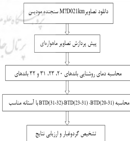
نگاره ۲: فلوچارت کلی تشخیص گردوغبار با استفاده از دمای روشنایی
