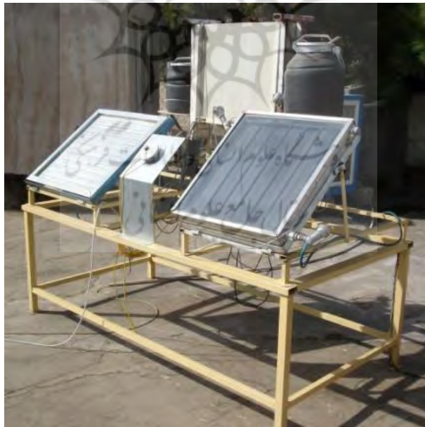
شکل ۴. تصویر دستگاه آزمون ساخته شده شامل کلکتور متداول (سمت راست) و جذب مستقیم (سمت چپ)
