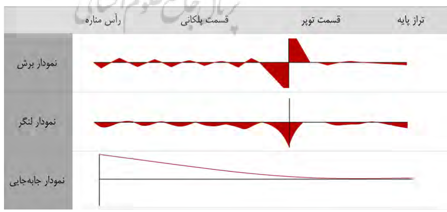
تصویر ۲۶: نمودار برش، لنگر و جابه‌جایی در طول مناره
