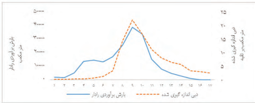
نگاره ۲۲: نمودار بارش برآوردی رادار و دبی اندازه‌گیری شده سیل ۲۹ فروردین ۱۳۹۵
