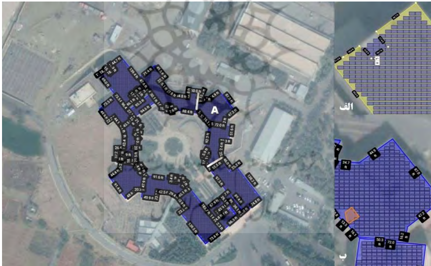
شکل ۲. تقسیم بندی ساختمان‌ها به ۱۳ بخش، الف: حذف مساحت‌های غیر قابل استفاده، ب: حذف مساحت‌هایی که توسط دیگر بناها تحت سایه نیم‌روزی قرار خواهند گرفت. (محیط نرم‌افزار HelioScope)
