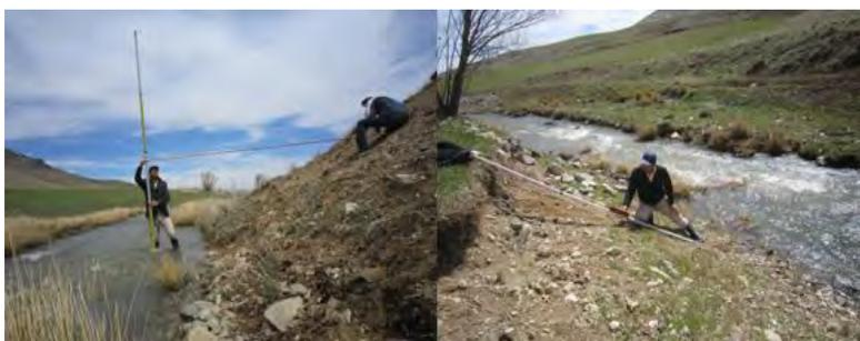
شکل ۳: تصویر کرانه رودخانه گلالی و نحوه اندازه گیری پروفیل کرانه رودخانه.
