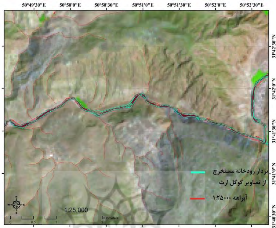
شکل ۴. انطباق رودخانه برداری مستخرج از تصاویر گوگل ارث با نقشه آبراهه ۱:۲۵۰۰۰ و تصویر رنگی کاذب (SWIR-NIR-RED) ماهواره لندست
