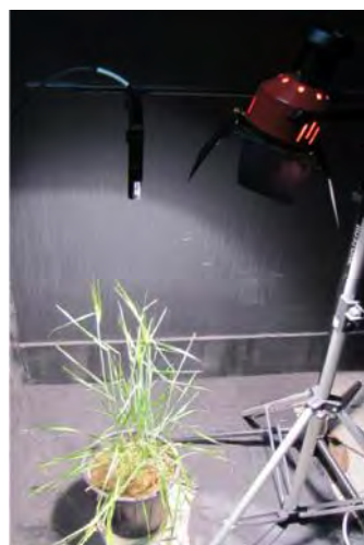
شکل ۳. روش اندازه‌گیری طیفی در اتاق تاریک
