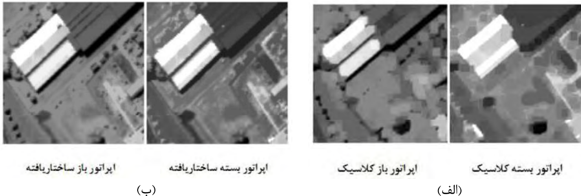
شکل ۳-الف. اپراتور باز کلاسیک و بسته کلاسیک؛ (ب) اپراتور باز ساختاریافته و بسته ساختاریافته بخشی از تصویر دانشگاه پاویا واقع در شمال ایتالیا (مجموعه اول از داده های ورودی)
