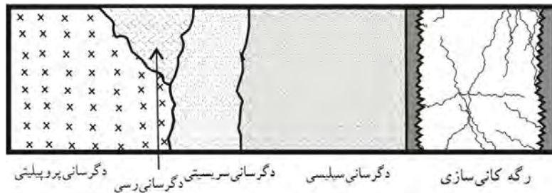
شکل ۳. مجموعه‌های دگرسانی گرمایی در اطراف رگه‌های کانی‌سازی و تغییر در کانی‌های اولیه سنگ‌دیواره (بدون مقیاس). اختصارات: دگرسانی پروپلیتی، دگرسانی سریسیتی، دگرسانی سیلیسی، رگه کانی‌سازی
