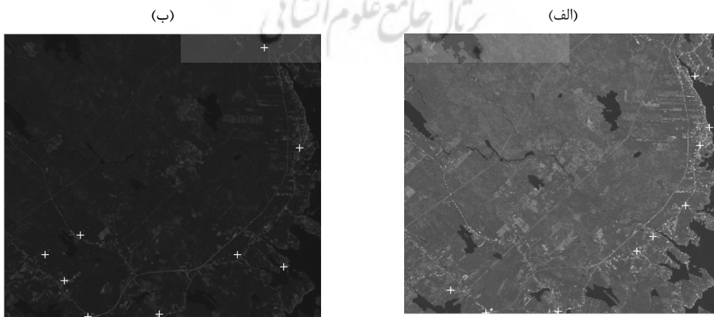
شکل ۸. نقاط استخراج شده با Harris: (الف) تصویر مربوط به سنجنده Spot 5 و (ب) تصویر مربوط به سنجنده Landsat ETM
