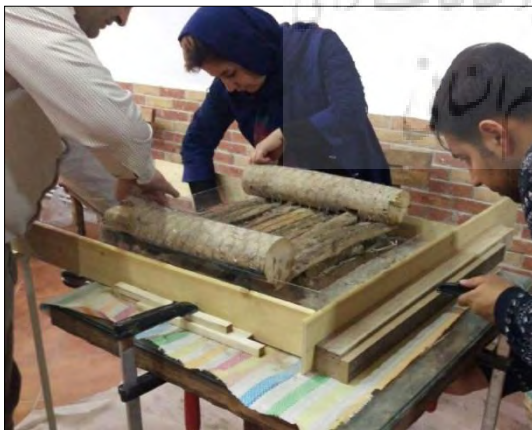
شکل ۵: قالب بندی نمونه اجرایی با لایه‌های تیرهای چوبی و لمبه کوبی، آستر و بستر
