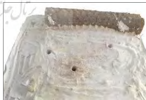
شکل ۸: سوراخ های ایجاد گردیده بر سطح لایه تخته گچی نمونه شبیه سازی شده
