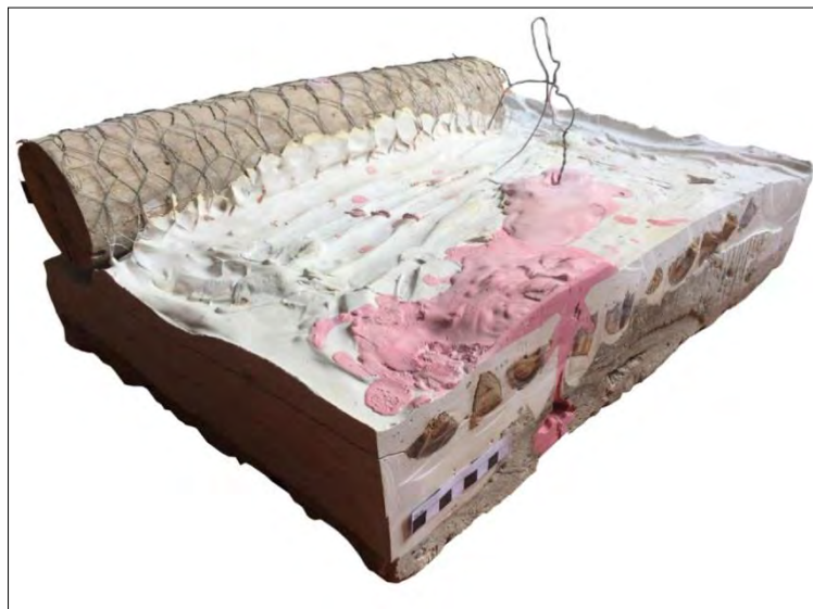
شکل ۱۱: برش ایزومتریک از نمونه شبیه‌سازی شده (لایه‌ها) به همراه سیم مفتولی برای مسلح کردن میخ‌گچی
