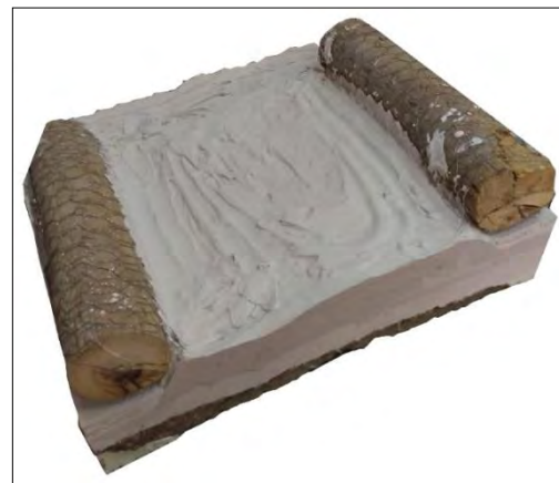
شکل ۶: شبیه سازی لایه آستر، بستر و لمبه کوبی (تکیه گاه چوبی) و ایجاد لایه تخته گچی برای استحکام بخشی اجزا به صورت قالب گیری شده
