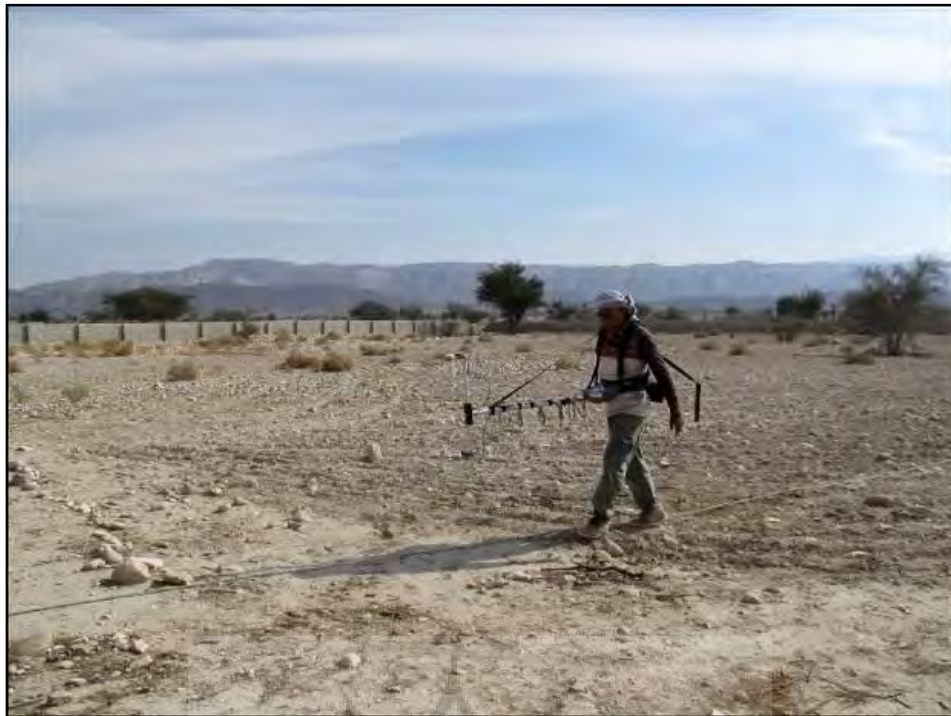
شکل ۹: نحوه‌ی بررسی مغناطیس‌سنجی در محوطه باستانی شهر سبیه با استفاده از دستگاه مغناطیس‌سنج سزیم-رئیدیم Fig. 9: Magnetic survey method in the ancient site of Sibeh city using Cesium-Rubidium magnetometer
