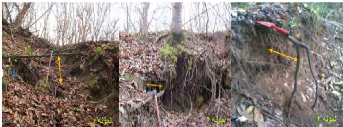
شکل ۱. نمونه‌هایی از موقعیت ریشه‌ها برای محاسبه میزان فرسایش زیرین (نمونه ۱) و جانبی گالی (نمونه‌های ۲ و ۳)
