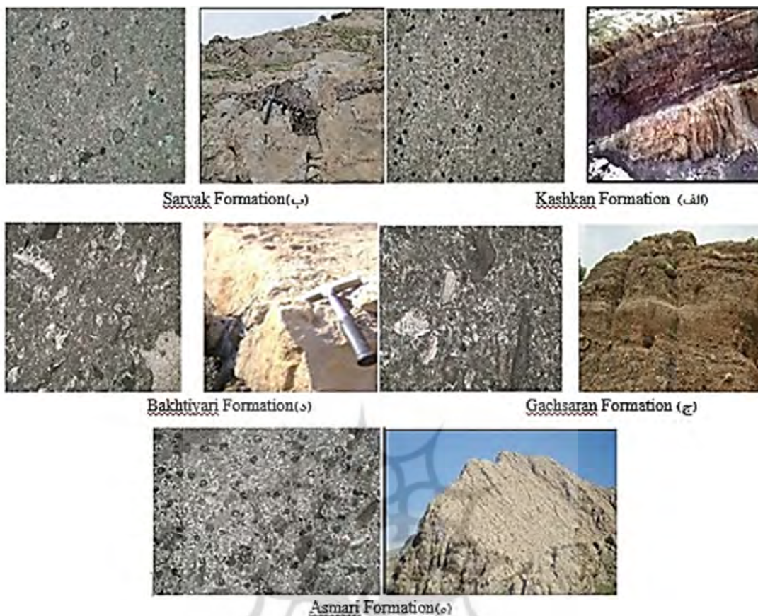
شکل ۴. (الف) نمای از واحد سنگی کشکان در جنوب خرم‌آباد (راست)، مقطع میکروسکوپی (چپ)؛ (ب) نمای از واحد سنگی سروک (راست)، مقطع میکروسکوپی نمونه (چپ)؛ (ج) نمای از واحد سنگی بختیاری (راست)، مقطع میکروسکوپی نمونه (چپ)؛ (د) نمای از واحد سنگی گچساران (راست)، مقطع میکروسکوپی (چپ)؛ (ه) نمای از واحد سنگی بختیاری (راست)، مقطع میکروسکوپی (چپ)
