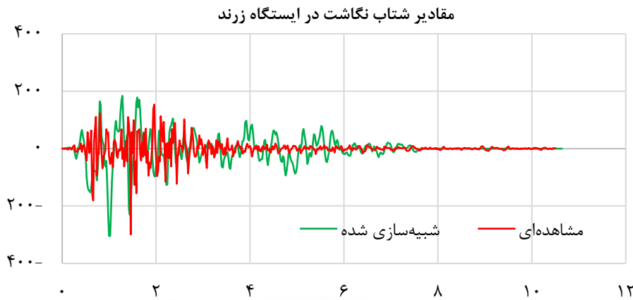
شکل ۷: مقایسه نتایج شتاب‌نگاشت مشاهده‌ای (قرمز) و شبیه‌سازی‌شده (سبز) براساس مشاهدات راداری پایین‌گذر در ایستگاه زرد
