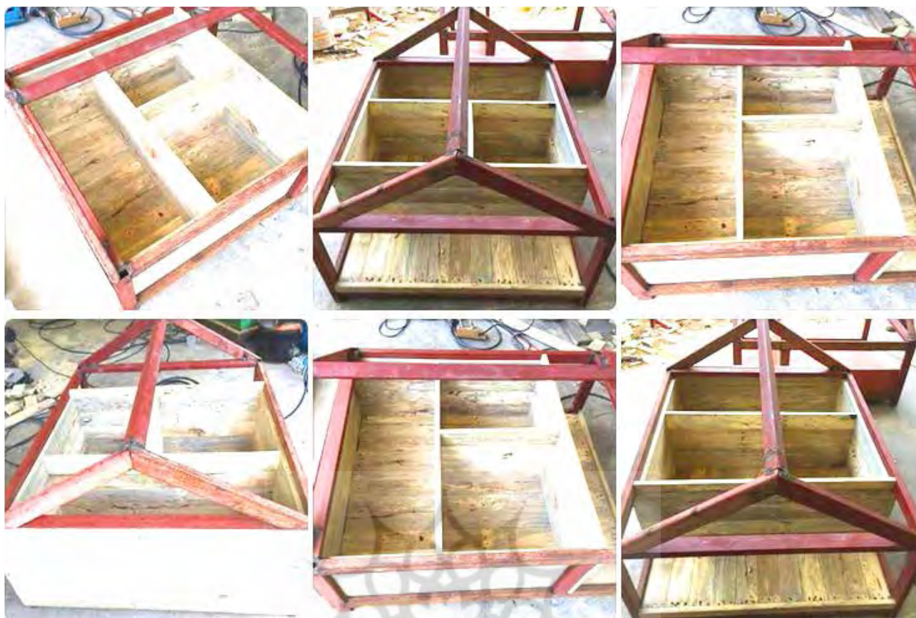
تصویر ۴: نمونه خانه مدل چوبی با اسکلت فولادی. مأخذ: نگارندگان.
