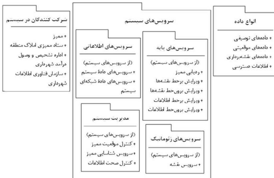
شکل ۱. ساختار بسته‌های مدل پشتیبان استاندارد ISO 19132 منبع: ISO/TC211, 2007
