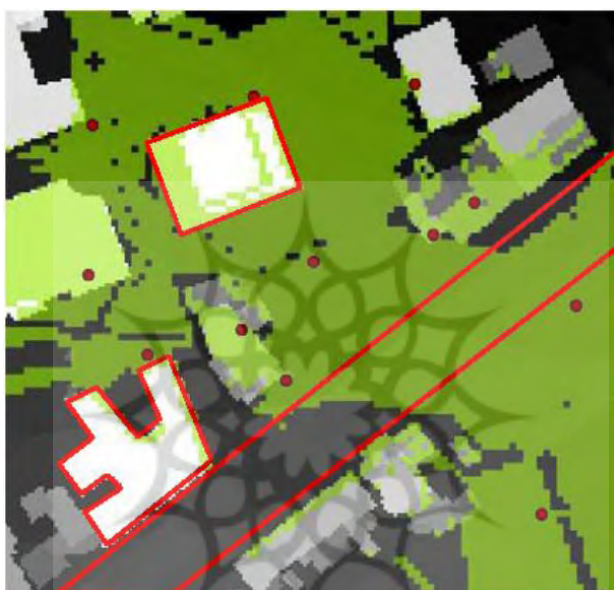
شکل ۵. نقشه پوشش و جایابی ۱۲ حسگر با استفاده از روش محیط آگاه، با توجه به خیابان و ساختمان به‌عنوان منطقه
