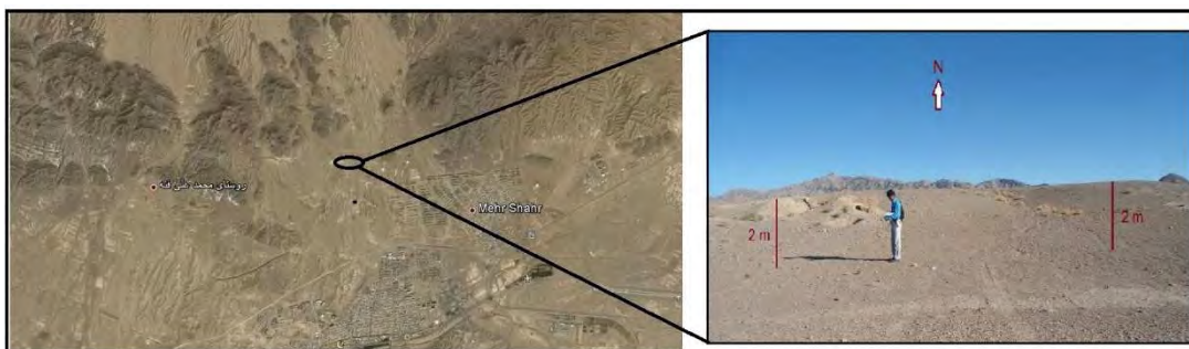
شکل ۱۲: تصویر ماهواره ای و میدانی از موقعیت پرتگاه گسلی در منطقه با ۲ متر ارتفاع قائم ( 32^{\circ}55'09'' N, 59^{\circ}13'27'' E).
