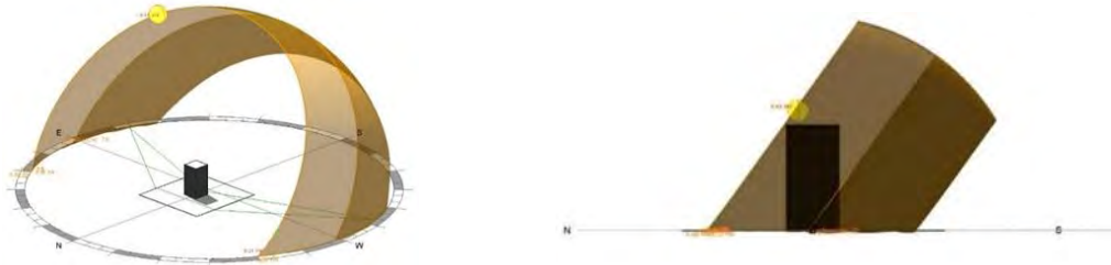
شکل ۱: برش از محدوده حرکت خورشید در طول یک سال و شکل ۲: پرسپکتیو از محدوده حرکت خورشید و سایه ایجاد شده در هنگام صبح. ایجاد محل سایه اندازه‌ی.
