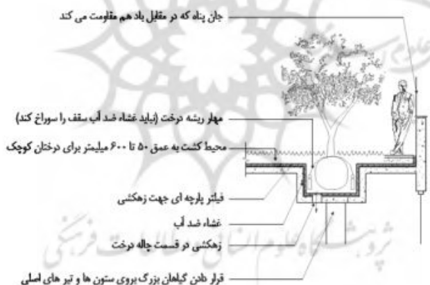
تصویر ۲: جزئیات اجرایی سیستم متمرکز (خسروی، محمودی، ۱۳۹۱)
