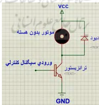
شکل ۶ - نحوه راه اندازی موتور بدون هسته
