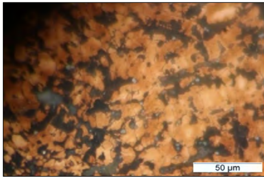
شکل ۱۱: ریزساختار میکروسکوپ نوری سکه شماره ۳۰ از دانه‌هایی با اندازه متفاوت دیده می‌شود بزرگنمایی ۴۰۰ برابر
